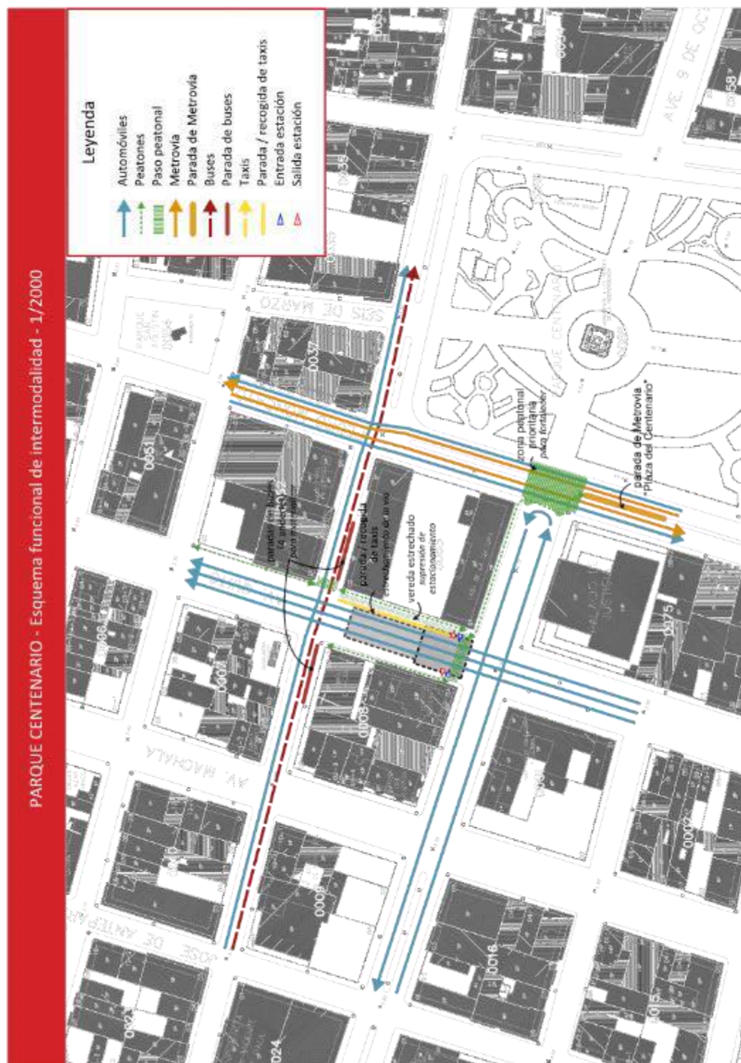
Figura 12. Implantación y funcionamiento de la estación "Parque Centenario"
