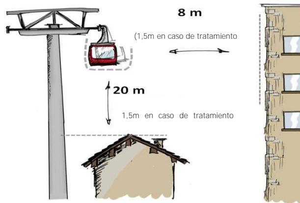
Figura 40: Distancias de sobrevuelo y gálibos para una red vial o edificios
