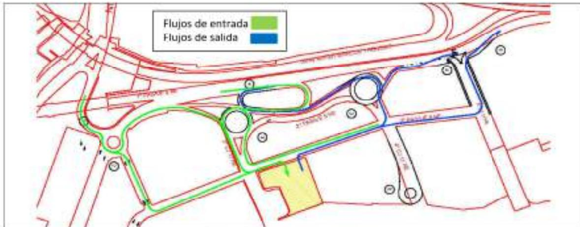
Figura 34 flujos de entrada y salida
