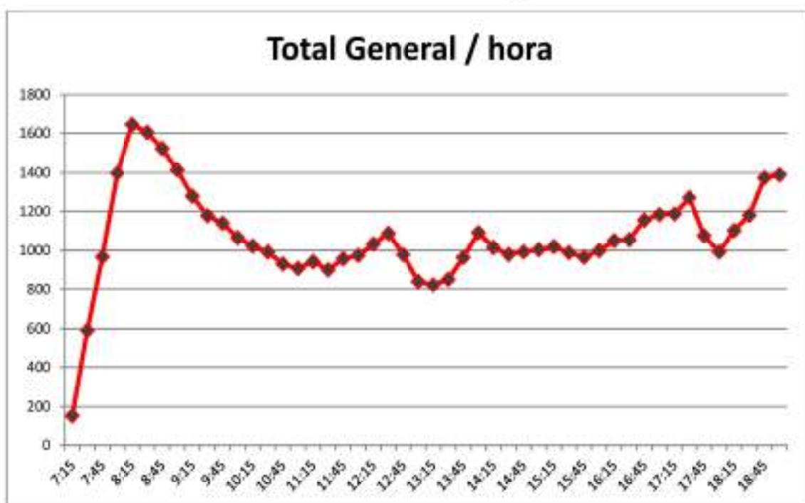
Figura 9 Histograma de volumen vehicular 12 horas del redondel 3
