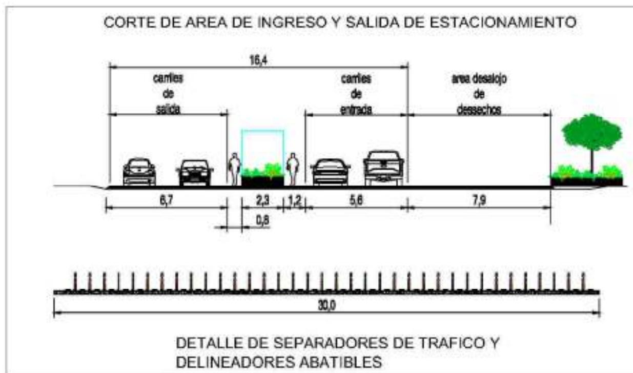
*Figura 37 sección vial de ingreso y salida del proyecto*
