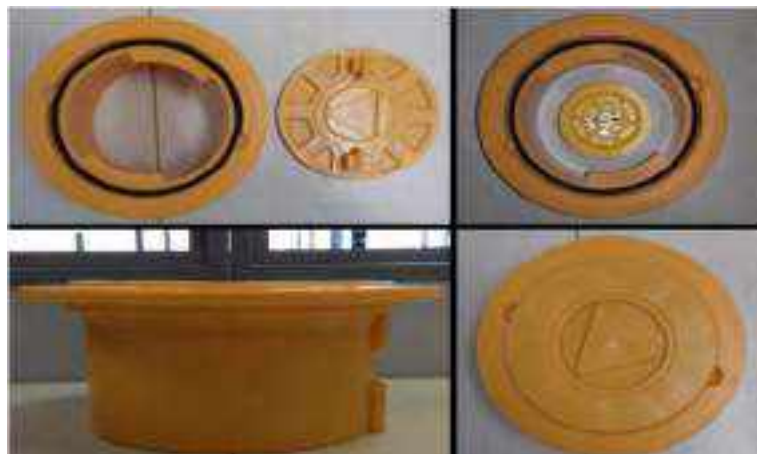
Ilustración 4.15. Elementos del sistema de muestreo de pozos
